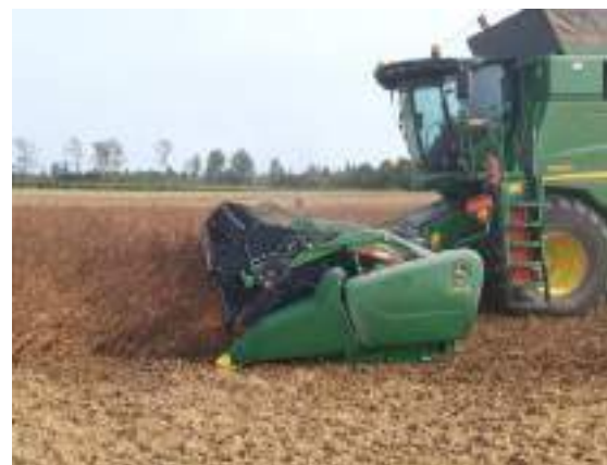
3.attēls. Sojas novākšana z/s ‘Rubuļi’, izmantojot hederi ar daudziem izkopts segmentiem, kas kopē lauka virsmu, 26.09.2020
